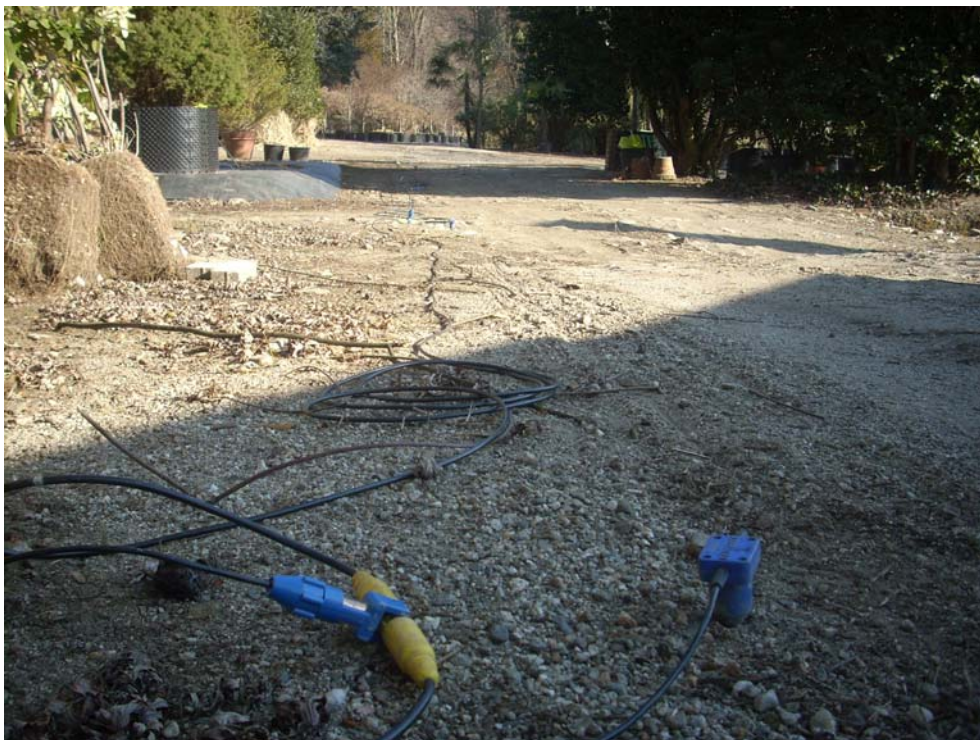
Figura 5. Stendimento con metodologia sismica a rifrazione LS.PD.05
