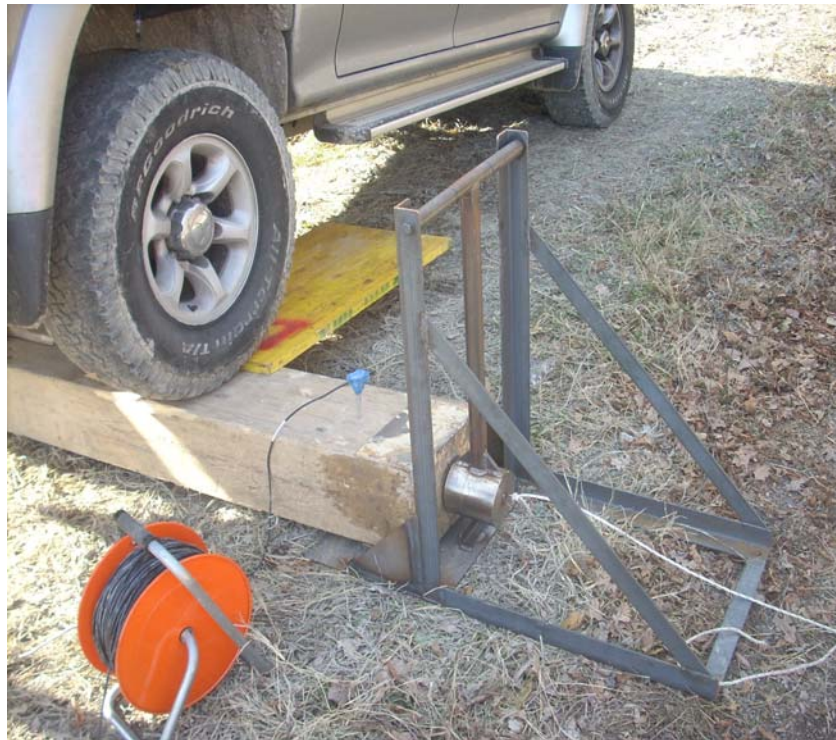
Evidenza del punto di energizzazione con onde S
