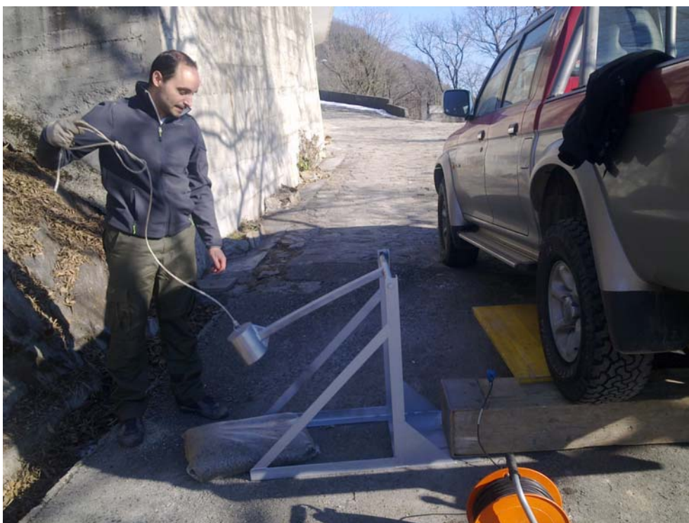
Figura 6. Indagine con metodologia Down-Hole DH.PD.01
