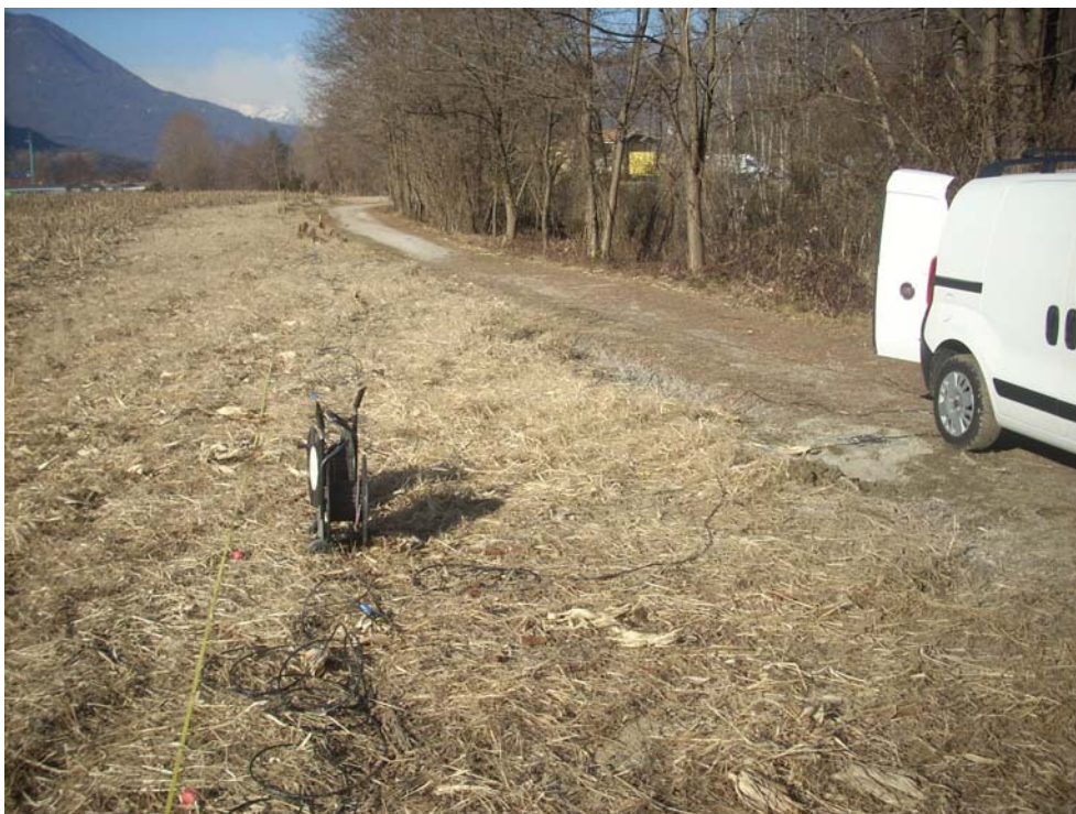
Figura 7. Stendimento con metodologia MASW MA.PD.01
