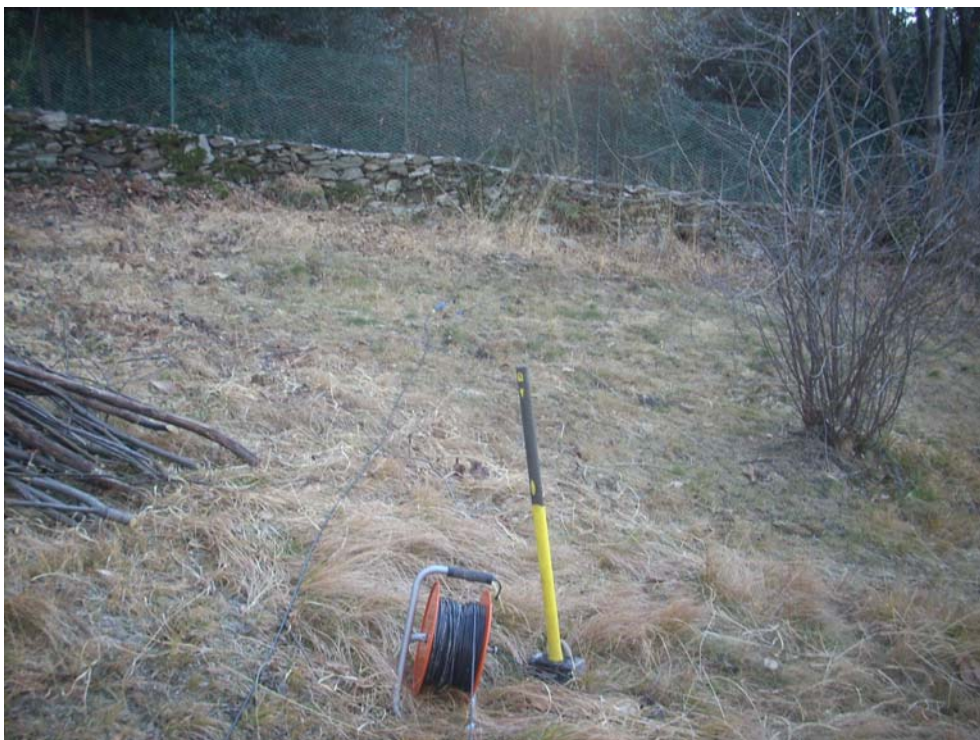
Figura 4. Stendimento con metodologia sismica a rifrazione LS.PD.04
