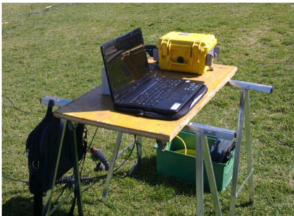
Figura 8. Strumentazione indagine: Pc e sismografo
